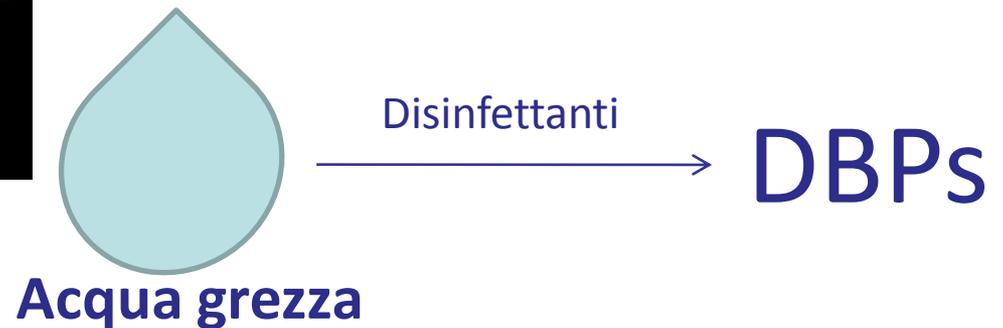
Il problema della formazione dei DBPs durante i processi di potabilizzazione è rilevante quando si impiegano disinfettanti a base cloro o HClO
